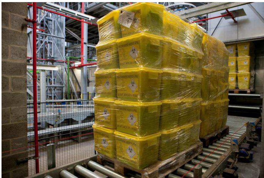
Foto 1. Sistema automático de alimentação do forno rotativo para resíduos hospitalares da Indaver nv (Bélgica). Em primeiro plano: tapete rolante com as paletes cintadas contendo os resíduos hospitalares a alimentar ao forno. Em segundo plano ao fundo: sistema elevatório que introduz os recipientes na tremonha que alimenta o forno. À esquerda: segunda linha de alimentação idêntica à que é apresentada em primeiro plano.
